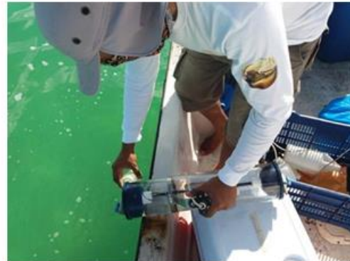
Figura 55.- Mateo Sabido de SEMA realiza la colecta de muestras de agua con la botella Van Dorn y deposita la muestra en frascos etiquetados para su almacenamiento y transporte al laboratorio de ECOSUR.
