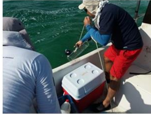
Figura 54.- El técnico de ECOSUR Alejandro Ortiz Arana, le da instrucciones a Mateo Sabido de SEMA sobre la forma de operar la botella tipo Varn Dorn para la colecta de muestras de agua.
