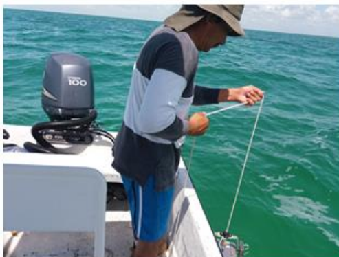
Figura 56.- Angel Gómez de SEMA utiliza la draga tipo Van Veen para la colecta de una muestra de sedimentos en la Bahía de Chetumal, y Juan Pastor de la Procuraduría de Protección al Ambiente del Estado de Quintana Roo transfiere la muestra a un frasco para su transporte.
