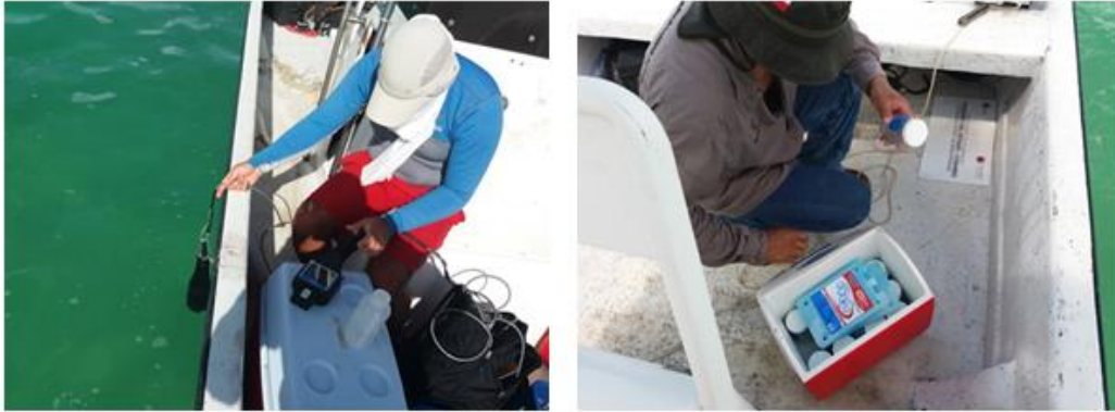
Figura 57.- Se realiza la medición de parámetros fisicoquímicos con una sonda multiparamétrica HORIBA en un sitio de monitoreo y se depositan muestras de sedimentos en una hielera para su transporte al laboratorio de ECOSUR.
