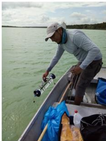
Figura 55.- Mateo Sabido de SEMA realiza la colecta de muestras de agua con la botella Van Dorn y deposita la muestra en frascos etiquetados para su almacenamiento y transporte al laboratorio de ECOSUR.
