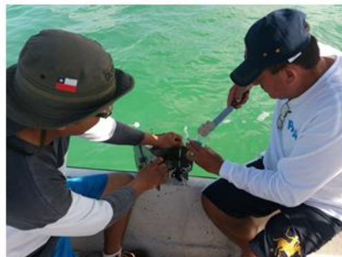
Figura 56.- Angel Gómez de SEMA utiliza la draga tipo Van Veen para la colecta de una muestra de sedimentos en la Bahía de Chetumal, y Juan Pastor de la Procuraduría de Protección al Ambiente del Estado de Quintana Roo transfiere la muestra a un frasco para su transporte.
